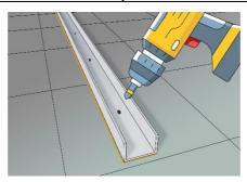
Une fois la totalité du profilé est recouvert, visser le profilé sur le support et monter la cloison.
