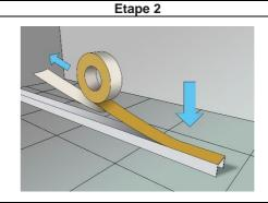
Poser Tecsound S50 Band 50 sur la face inférieure du profilé. Retirer progressivement le film de protection et faire adhérer sur la totalité du profilé en appuyant progressivement sur toute la surface.
